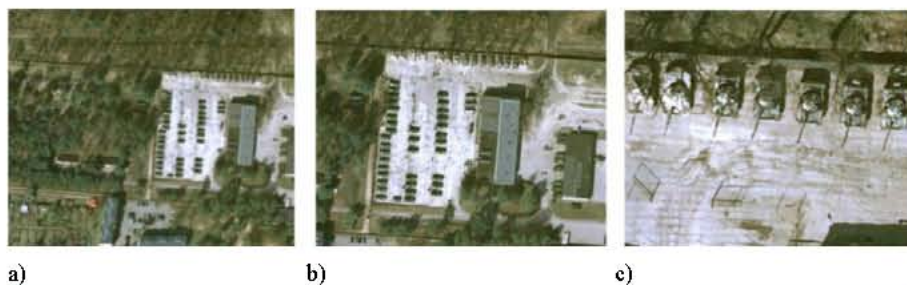
■ Rys. 10.1. Stopnie rozpoznania obrazowego: a) detekcja, b) rozpoznanie, c) identyfikacja [14]
