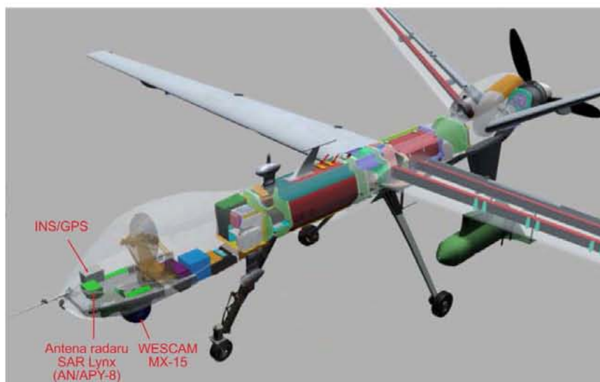
■ Rys. 11.1. Urządzenia systemu obserwacyjnego MQ-8 Reaper [144]
